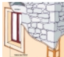
Enduit avec chaînes d'angle et encadrement peints
